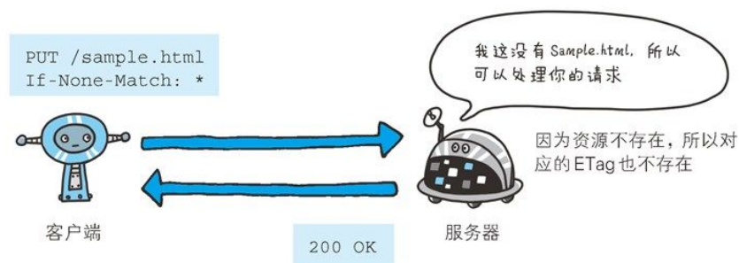
图：只有在 If-None-Match 的字段值与 ETag 值不一致时，可处理该请求。与 If-Match 首部字段的作用相反
