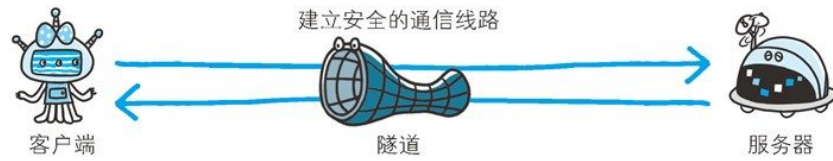
图：通过隧道的传输，可以和远距离的服务器安全通信。隧道本身是透明的，客户端不用在意隧道的存在
