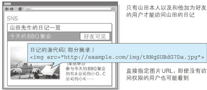
图：强制浏览导致安全漏洞的案例
